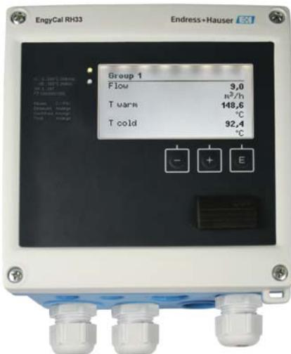
El medidor de BTU mide el flujo energético en un circuito de calefacción/refrigeración a partir del caudal volumétrico y las temperaturas en la entrada y salida (diferencia de temperaturas) de un intercambiador de calor.
